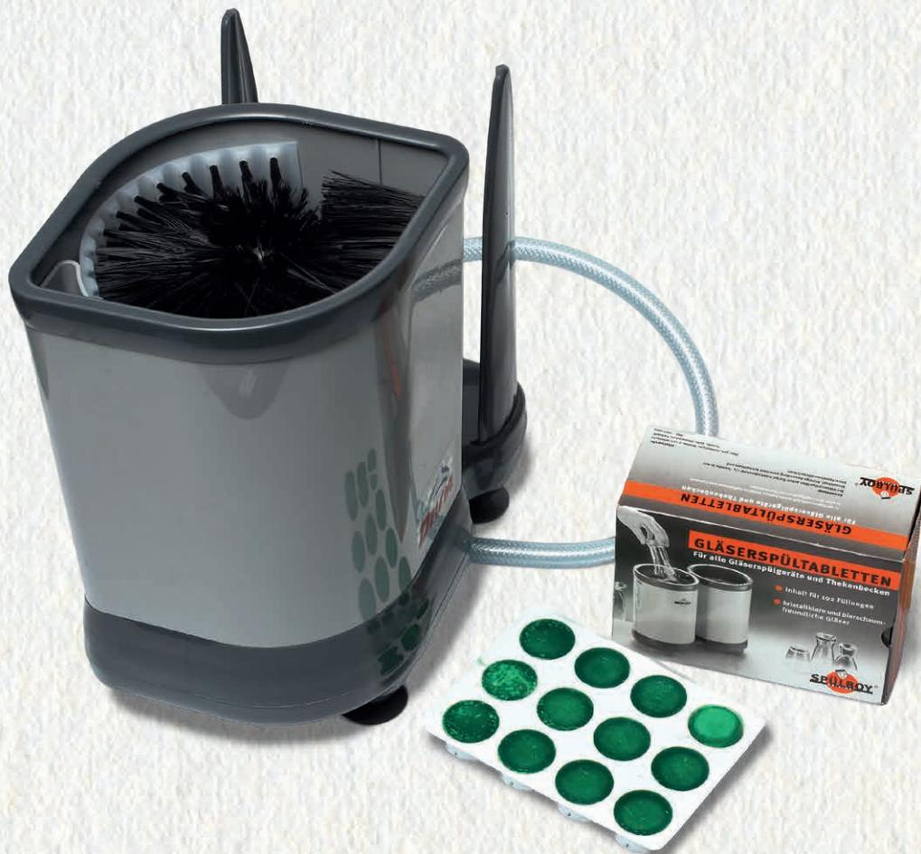
Ein Gläserreiniger, auch Spülboy genannt, ist für das manuelle Reinigen und Nachspülen von Gläsern in allen Größen geeignet. Er kommt zum Einsatz, wenn keine Gläserspülmaschine vorhanden ist oder nur ein Spülbecken statt zwei, wie z. B. im Ausschankwagen. Ein Stromanschluss wird nicht benötigt, da man den Gläserreiniger am Wasserhahn anschließt und mit speziellen Spültabletten benutzt.
